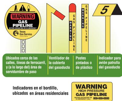
En áreas rurales, un derecho de vía de tuberías se puede detectar fácilmente al buscar señalizadores de línea como los que se ven en esta imagen, que son utilizados para indicar la presencia de una tubería subterránea. Sin embargo, en áreas pobladas no siempre se utilizan señalizadores de línea, por lo que es muy importante siempre llamar al 811 antes de empezar una excavación para que las líneas subterráneas de gas natural y otros servicios queden debidamente localizadas y señalizadas.
